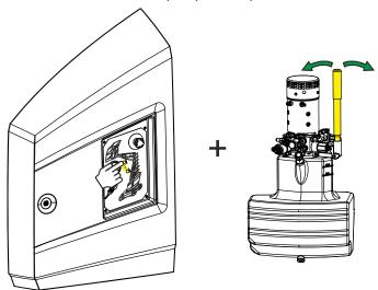
Figure 3-9. Boom Manual Lift Up Valve
